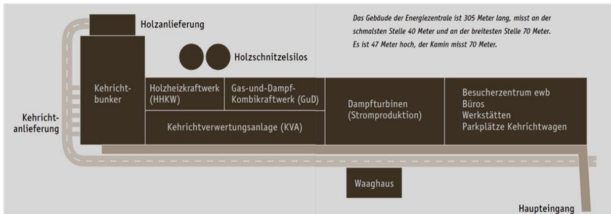
Fig. 2: Grundriss und Dimensionen der Energiezentrale Forsthaus Bern (Energie Wasser Bern 2013) Fig. 2: Layout plan and dimensions of Energiezentrale Forsthaus Bern
